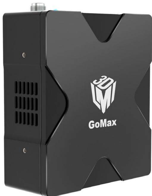
GoMax® は、インライン生産速度を満たすために、任意の Gocator® センサーを加速するための費用効果の高いハードウェアソリューションを提供しています。GoMax の小型フォームファクター、専用データ処理、イーサネットを介した連続データフィード、および検査エラーからの自動回復により、エンジニアは産業用 PC を置き換えることができます。
