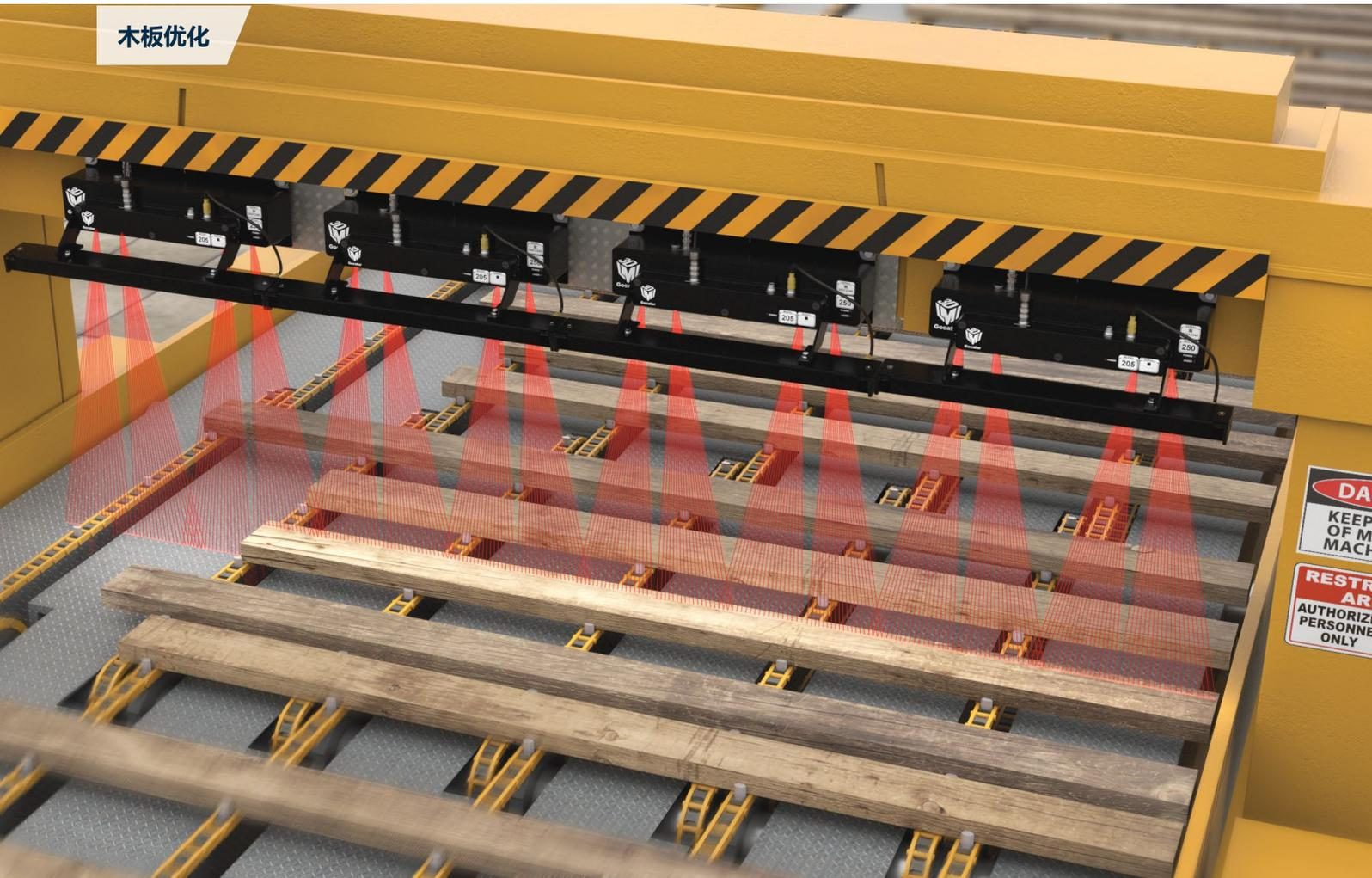
Gocator 200扫描仪生成轮廓，颜色和管胞数据，实现可回收最大化
