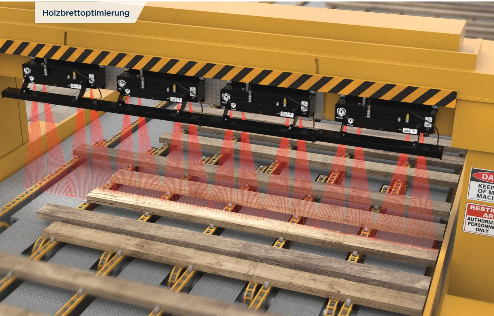
Gocator 200 Scanner generieren Profil-, Farb- und Tracheid-daten für die maximale Wertausschöpfung bei Brettern.
