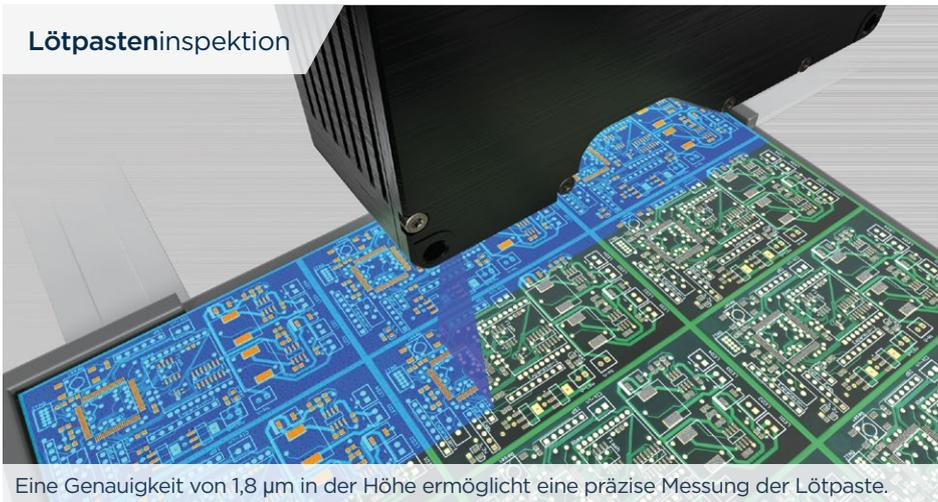
Eine Genauigkeit von 1,8  $\mu\text{m}$  in der Höhe ermöglicht eine präzise Messung der Lötpaste.
