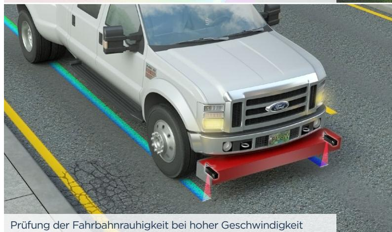
Prüfung der Fahrbahnrauigkeit bei hoher Geschwindigkeit
