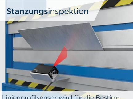
Linienprofilsensor wird für die Bestimmung des Biegewinkels in einer Abkantpresse genutzt
