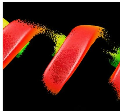
相同曝光下，红光的扫描数据输出更完整的点云
