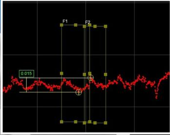
브레이크 로터의 인라인 표면을 최고 1.1 $\mu$ m Z 해상도로 검사. 최대, 최소 높이를 측정하고 평균을 계산하여 허용 가능한 표면 마무리를 결정합니다.
